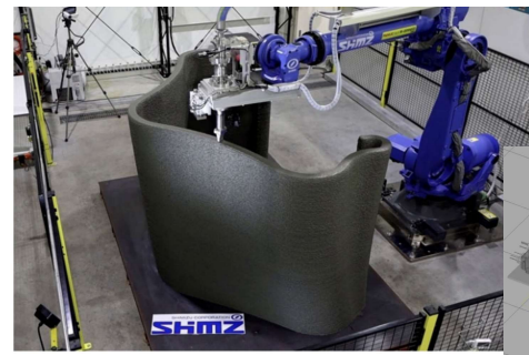
繊維補強モルタルの積層造形によるコンクリート柱の型枠施工（清水建設，2021年）
